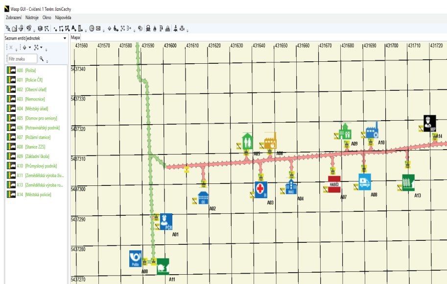
Obrázek 10: Schéma rozvodné sítě v simulátoru s vyznačenou závadou
